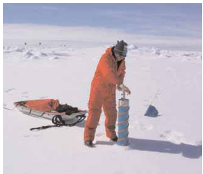
Kernbohrung auf dem antarktischen Meereis
