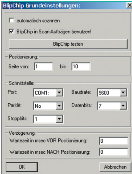
Abb.: BlipChip-Controller Einstellungen
