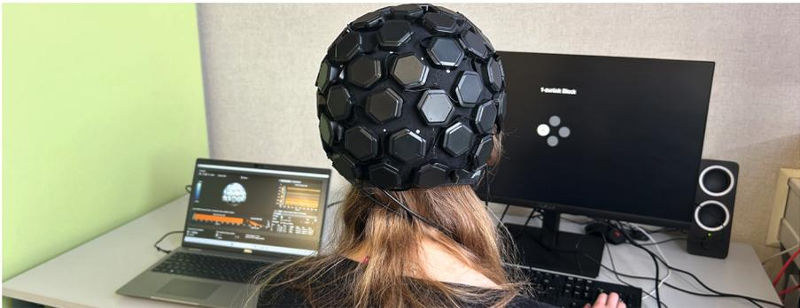
Das Lumo54-System ermöglicht hochauflösende funktionelle optische Tomographie für die gesamte Großhirnrinde
