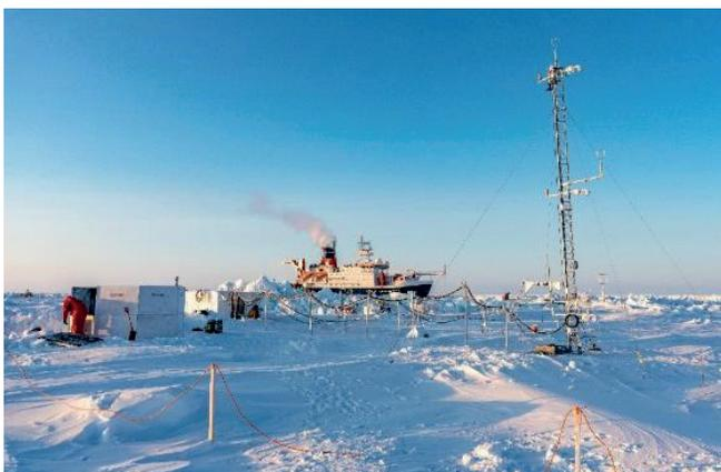
Die atmosphärische Messstation („Met City“) auf dem Eis Ende März 2020. Im Vordergrund der 11 Meter hohe und voll instrumentierte Messturm (re.) und der Schallschutz des Sodars (li.), dahinter zahlreiche Strom- und Datenkabel sowie die Met-Hütte. Im Hintergrund FS Polarstern. Foto: Christian Rohleder
