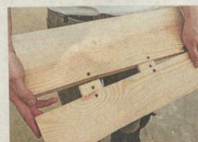
Nut und Feder: Das passgenaue Zusammenfügen der Planken ohne Nägel ist eine der größten Herausforderungen bei dem ungewöhnlichen Schiffsbau-Projekt.
