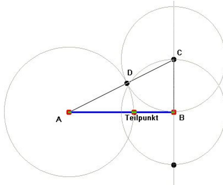
Im Endpunkt der Strecke AB wird die Senkrechte errichtet. Auf ihr trägt man die Hälfte von AB ab. Es ergibt sich Punkt C. Der Kreis um C mit dem Radius CB schneidet AC bei D. Überträgt man den Abstand AD auf die Strecke AB, so ergibt sich der Teilpunkt T. T teilt AB im Verhältnis des Goldenen Schnittes.
