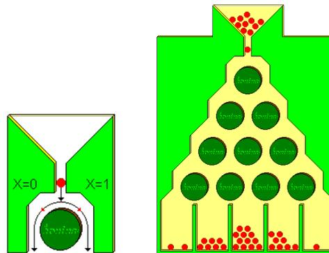
Sind wir nur an der Zahl  $j$  der Zahl-oben-Ereignisse bei einem wiederholten Münzwurfexperiment interessiert, so entspricht dies der Zahl der Kugeln im  $j$ -ten Fach des  $n$ -fach kaskadierten Galtonbretts.  $n$  über  $j$  von insgesamt  $2^n$  Möglichkeiten (elementaren Ereignissen) beinhaltet dieses Ereignis.
