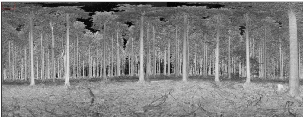
Abbildung 6: Darstellung eines Panorama-Rasters. Ersichtlich sind die Intensitätswerte der TLS-Messung des Plots 15b. Helle Bereiche bedeuten hohe, dunkle Bereiche geringe Intensitäten.
