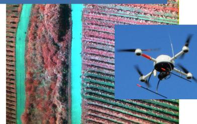
Die als Quadropter bezeichnete Drohne ermöglicht es, die Maßstabslücke zwischen Bodenbeobachtungen und Flugzeug- oder Satellitengestützte Fernerkundung zu schliessen. Ausgerüstet mit unterschiedlichen Kamerasystemen, wie z.B. Fotokamera, 6 Kanal-Multispektralkamera sowie einer Thermalkamera, lässt sich mit der Drohne geometrisch sowie temporal hoch aufgelöste Daten für geowissenschaftliche Fragestellungen zu erfassen.
