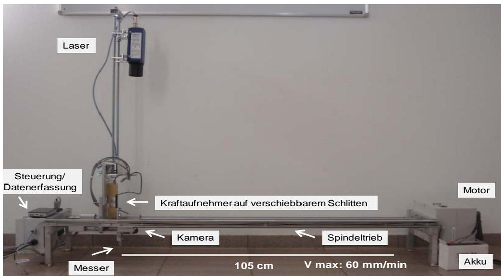
Abb. 1: Mobiles 4S-Schergerät (Prototyp)
