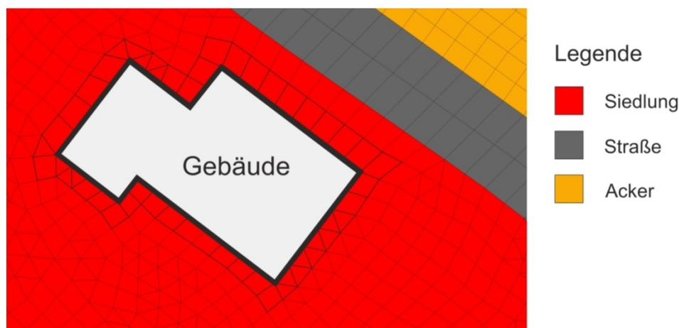
Abb. 2: Simulationsnetz mit ausgestanzter Gebäudefläche
