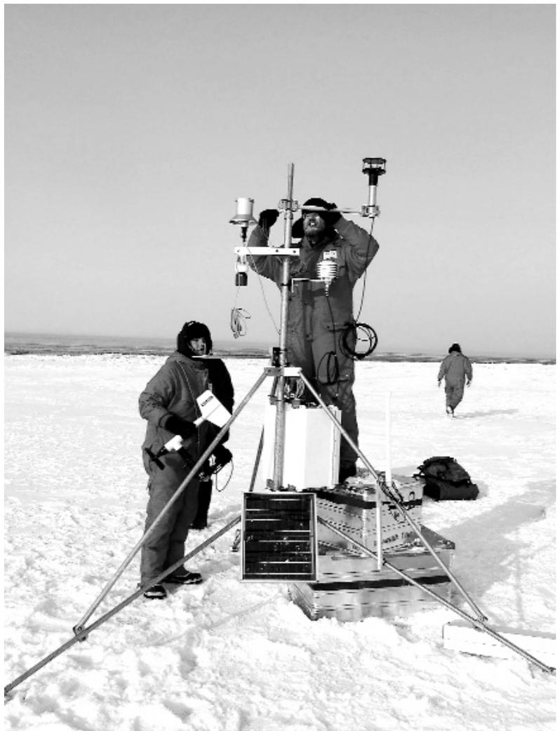
Abb.4: Trierer Umweltmeteorologen im Einsatz: Aufbau einer Wetterstation am Polynja-Rand.
