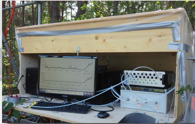
sator der Geobotanik mit angeschlossener Wasserdampf-Isotopenstandardquelle zum Einsatz. Diese Geräte waren von der Geobotanik im Sommer 2016 nach Bewilligung eines DFG-Antrags auf Beschaffung von Forschungs Großgeräten erworben worden und konnten nach Testläufen im Labor nun erstmals im Freiland genutzt werden - für derartige Zwecke sind sie auch konzipiert und entsprechend beantragt worden.
