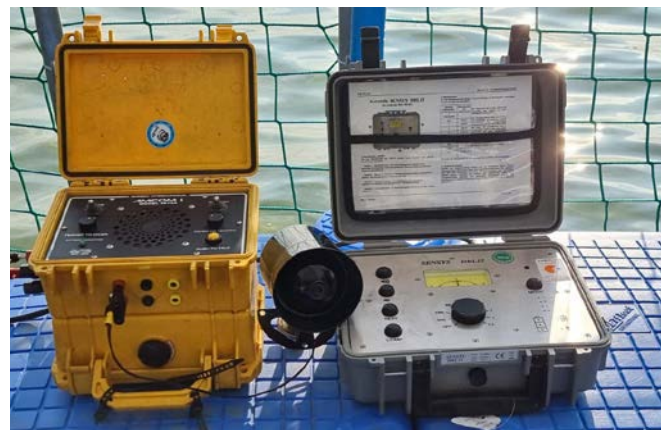
Abb. 52 Tauchertelefon zur Kommunikation der Taucher untereinander oder mit dem Signalmann
