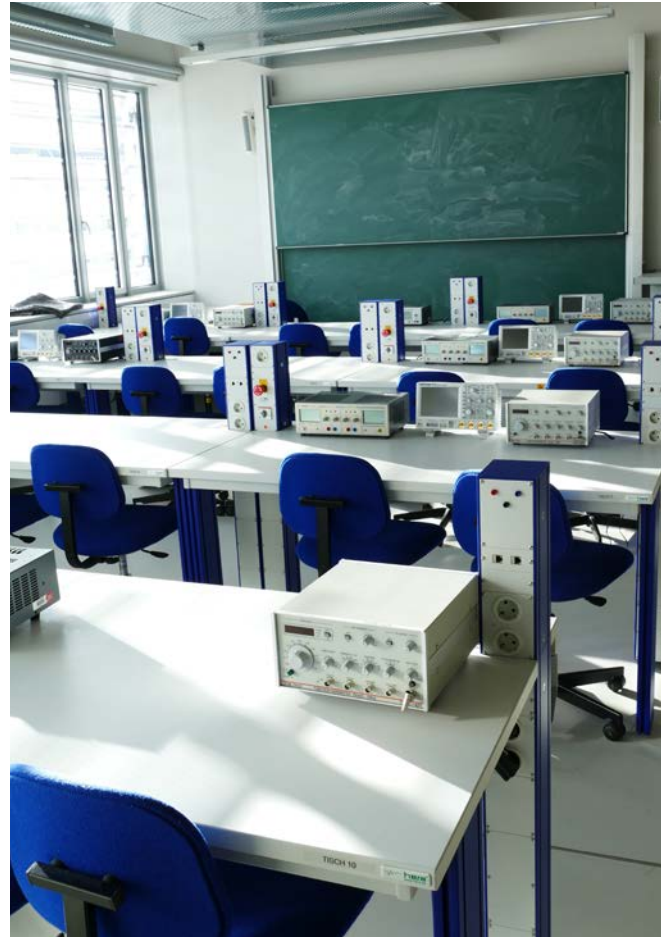
Abb. 20 sichere Anschlusspunkte in einem Übungsraum
