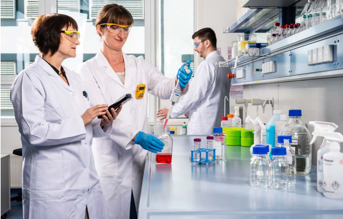
Abb. 33 Arbeits- oder Schutzkleidung und Handschuhe können vor Kontaminationen schützen
