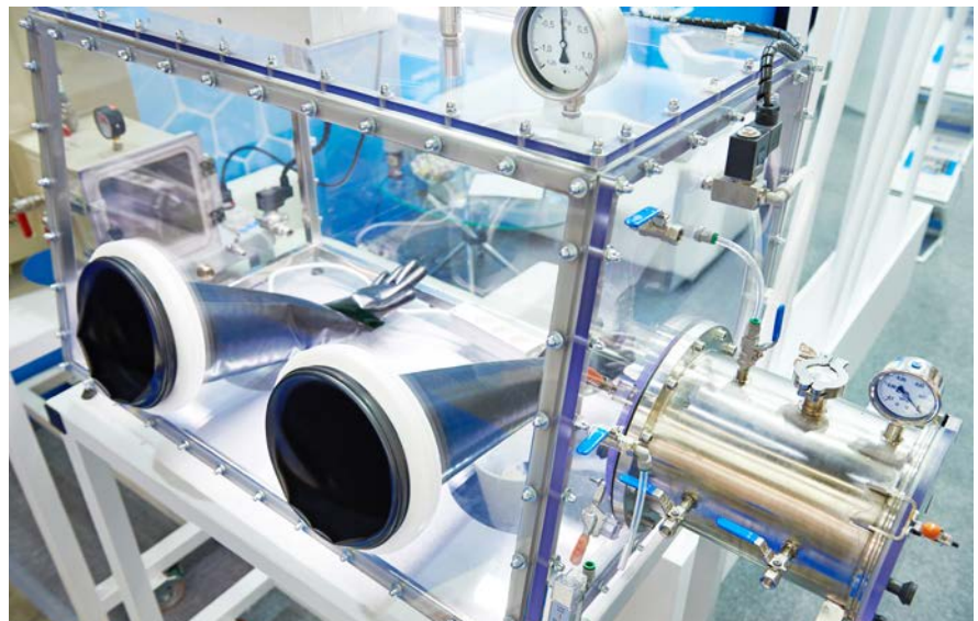
Abb. 48 Glovebox für Tätigkeiten unter Inertgas Bedingungen bei Verwendung von luft- oder wasserempfindlichen Substanzen
