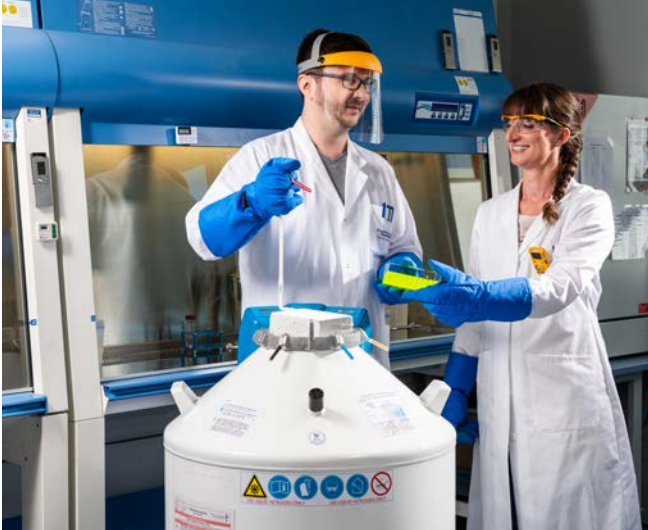
Abb. 36 PSA für Tätigkeiten mit tiefkalt verflüssigten Gasen
