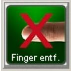
Bei aktivierter Funktion **Finger entfernen** wird der Scan auf der rechten und linken Seite nach Fingerspitzen abgesucht um diese aus dem Bild zu entfernen.
